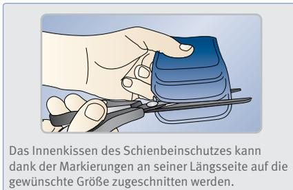
Das Innenkissen des Schienbeinschutzes kann dank der Markierungen an seiner Längsseite auf die gewünschte Größe zugeschnitten werden.
